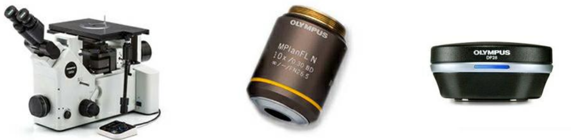
Configuração típica do equipamento: microscópio metalúrgico invertido, lente objetiva de 10X e uma câmera digital de alta resolução para microscópio
